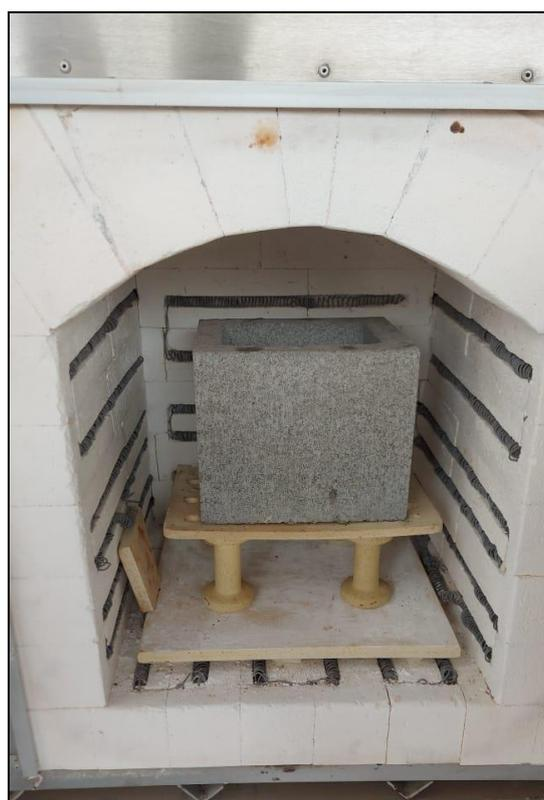
*7.7 Ensaio de resistência ao fogo.*
